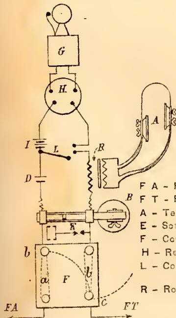
Nota - Portando la leva *a* da *b* in *c* si isola l'apparecchio e si mette in comunicazione il filo aereo con quello di terra.
