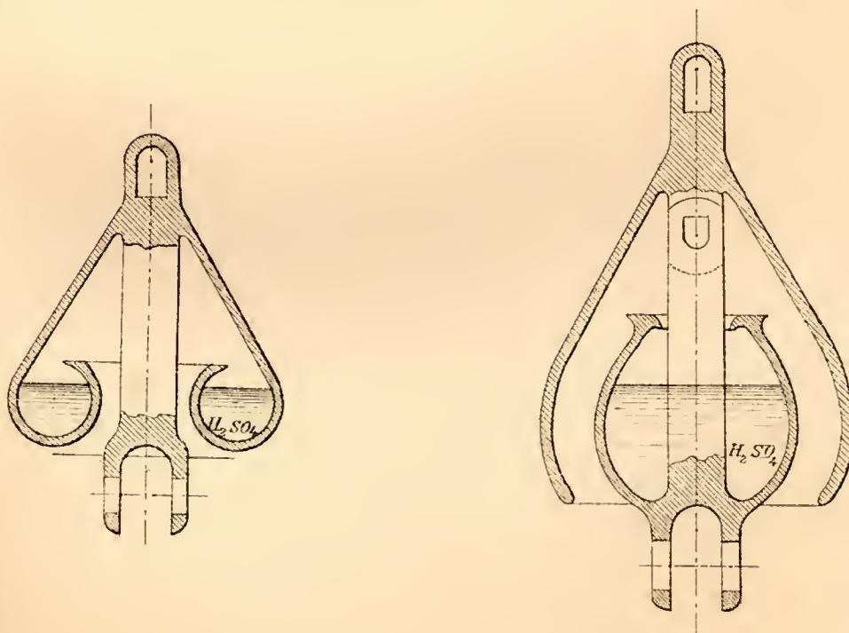
Sistema isolante per filo aereo delle stazioni di telegrafia senza fili.
